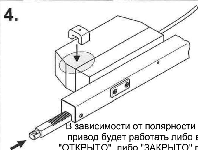
В зависимости от полярности напряжения привод будет работать либо в положении "ОТКРЫТО", либо "ЗАКРЫТО" при работе в отсутствие оператора.
